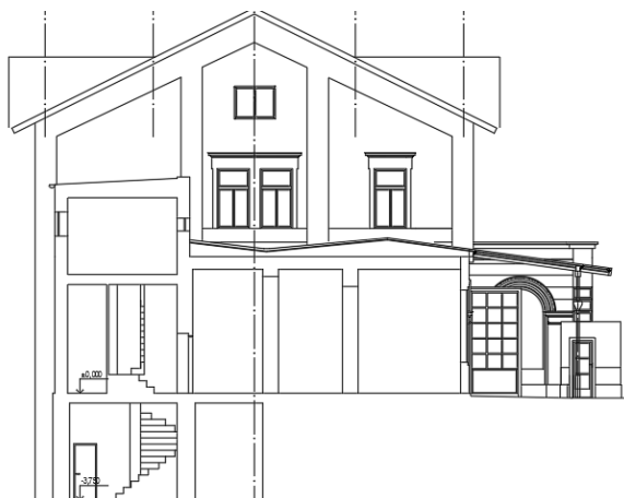
Obr. 6 Příčný řez v místě spojovací krčku mezi sedlovou a valbovou střechou
